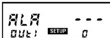
Obr. 45 Nastavení výstupu OUT1 do funkce alarmového výstupu
