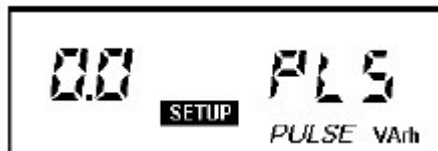
Obr. 44 Pulzní výstup nastavený na vysílání informace o jalové energii (VARh/pulz)
